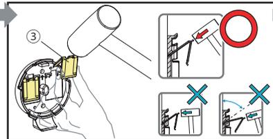
固定金具をハンマーで打ち込みます。金具の打ち込み角度にご注意ください。
