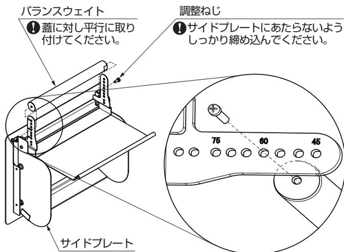
【1】 バランスウェイト両端の調整ねじを外し45°、60°、75°の3ヶ所の刻印を目安に取付位置を変更してください。
