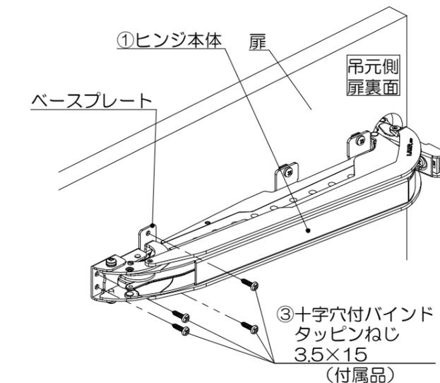
●ベースプレート側と座金取付側のヒンジ取付ピッチが等しくなるように取り付けてください。
