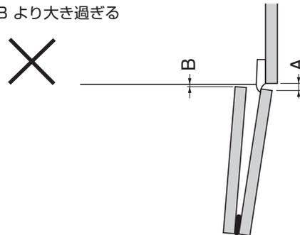
扉の前後調整の際、吊元扉の持ち出し量AはBと同じくらいになるようスライドガイド①（専用丁番）とスライド丁番②を調整してください。図のように正しく開きます。
