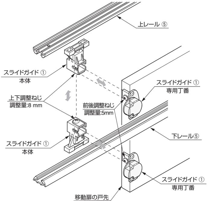
スライドガイド①(本体)の高さを、レールとのすき間が 0.5mm になるように調整してください。
