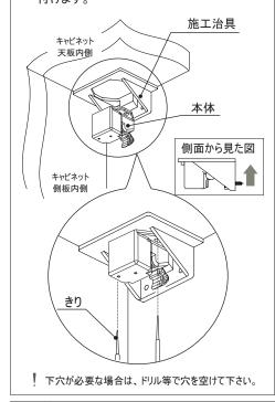
② 取付けネジで取付けます。
